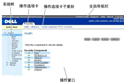
图 5-2 显示具有管理员权限的用户在模块化系统上登录时的 Server Administrator 主页的样式。
